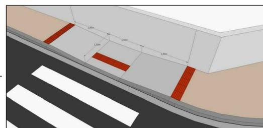
DETALHAMENTO DE RAMPA - MODELO 06 DA PLANILHA
