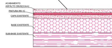
DETALHE CAMADA DE RECAPEAMENTO DE PAVIMENTAÇÃO EM CBUQ SEM ESCALA
